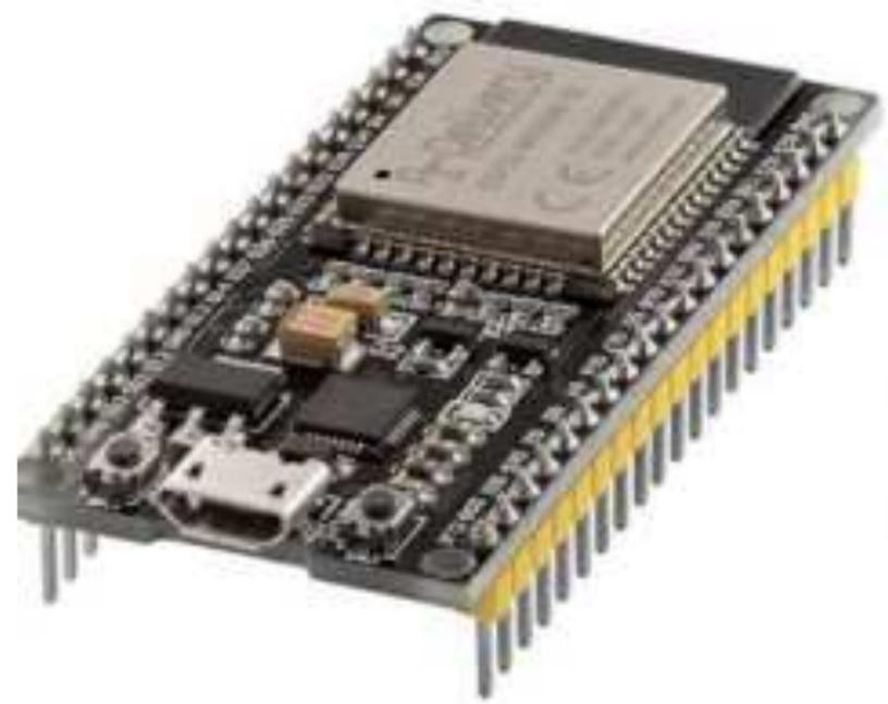
AZDelivery ESP32 NodeMCU Development Board compatible avec Arduino
